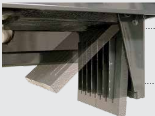
Автоматично почистване посредством падаща скара
